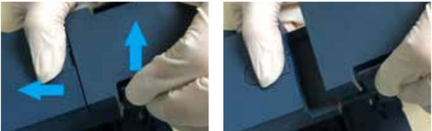
Entfernen Sie das Puffer Kit von der Puffer Kit Halterung.
